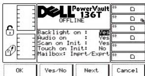
图 75. 设置 > 实用程序 > 配置对话框
