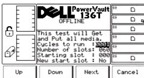
图 93. 维修 > 磁带库 > 诊断 > 夹紧装置 > 获取/放置对话框
