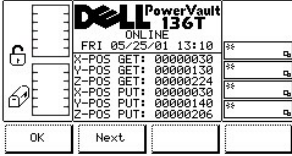
图 17. 状态 > 磁带库 > 槽位 > X、Y、Z 位置槽位对话框
