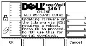
图 89. 维修 > 磁带库 > 固件更新对话框
