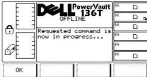
图 54. 命令 > 驱动器 > 卸载 > 命令处理对话框
